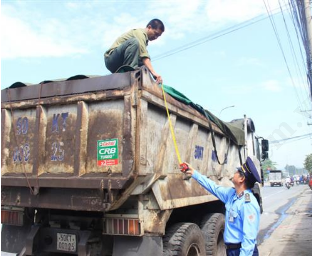
Lực lượng thanh tra GTVT kiểm tra kích thước thành thùng.
